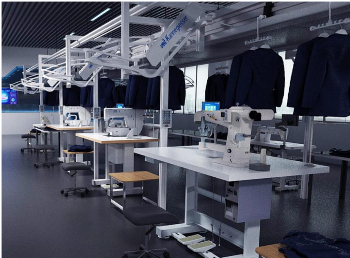
图 1 服装智能制造实训工厂（智能吊挂生产车间）实景参考图
